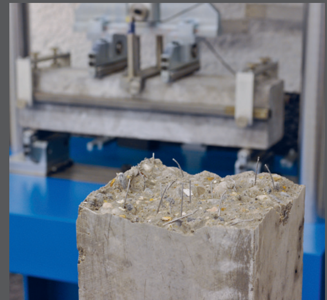
Deformationsgesteuerter Biegezugversuch an faserarmiertem Betonprisma
